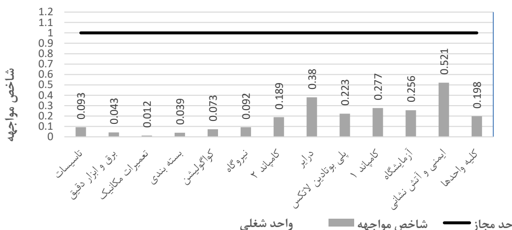
نمودار ۱- مقادیر شاخص مواجهه تنفسی با ۳،۱- بوتادین (E p ) در واحدهای شغلی مختلف
