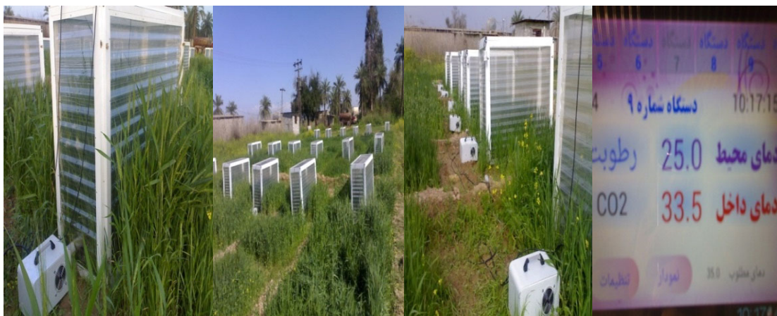
شکل ۱. دستگاه اتاقک تولید تنش حرارتی گیاه مستقر در مزرعه تحقیقاتی دانشگاه علوم کشاورزی و منابع طبیعی خوزستان.
