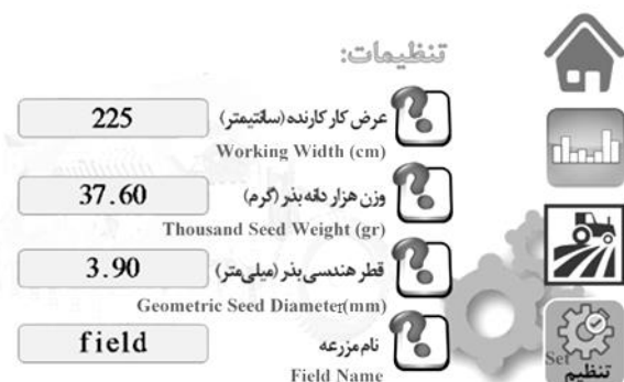
شکل (۷) صفحه تنظیمات سامانه پایش در رابط گرافیکی
