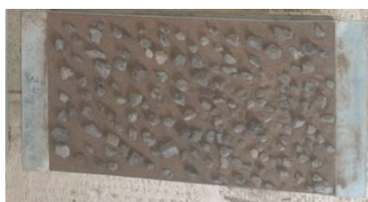
ب) سینی نمونه با پوشش سنگریزه ۳۰٪ B) the sample tray with gravel cover 30%
