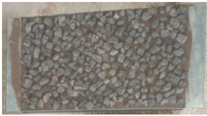
ت) سینی نمونه با پوشش سنگریزه ۷۵٪ D) the sample tray with gravel cover 75%
