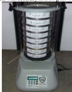
د) دستگاه لرزاندنده مورد استفاده برای عملیات الک کردن ذرات D) the vibrating device used for particle sieving operations
