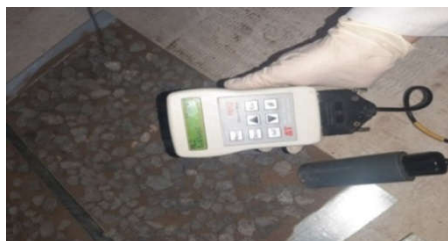
ب) اندازه‌گیری رطوبت سینی نمونه ذرات شن و ماسه با رطوبت‌سنج
