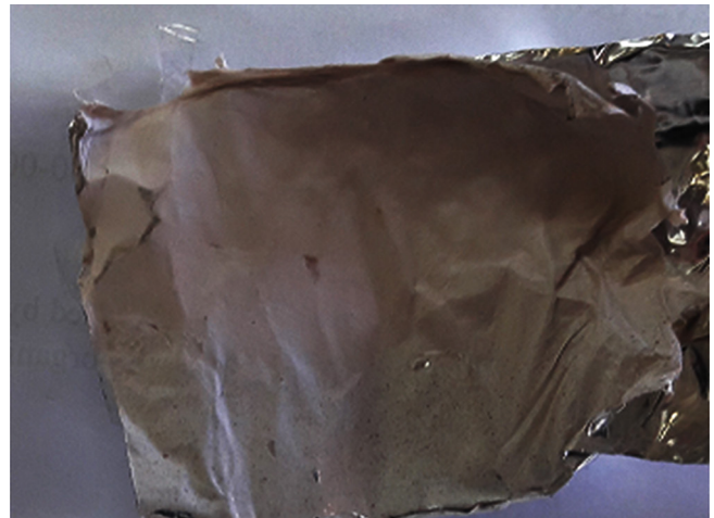
شکل ۵- نانوالیاف \{\text{Mo}_{132}\} /PAN حاصل از فرایند الکترورسی روی ورق آلومینیم.
