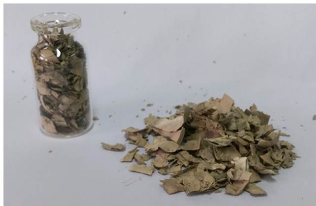
شکل ۹- نانوالیاف‌های کامپوزیتی TiO_2 -CuO پس از تکلیس. Fig. 9. TiO_2 -CuO composite nanofibers after calcination.
