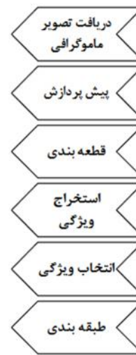
شکل ۱- مراحل کلی طی شده در یک سیستم CAD
