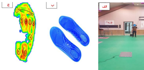
شکل ۱: (الف) مسیر راه رفتن و دستگاه فوت اسکن، (ب) کفی بافت‌دار، (ج) نواحی ده‌گانه پا طی راه رفتن با کفی بافت‌دار
