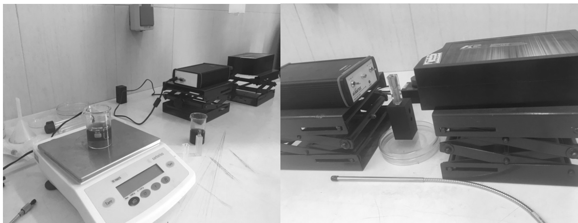
شکل ۱. آرایه طیف نگاری برای آزمون طیف نوری عبوری از دمنوش کرنبری و زغال اخته
