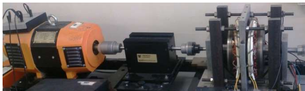
شکل ۹: میز آزمایشگاهی مورد استفاده جهت محاسبه نیروی محرکه القایی
