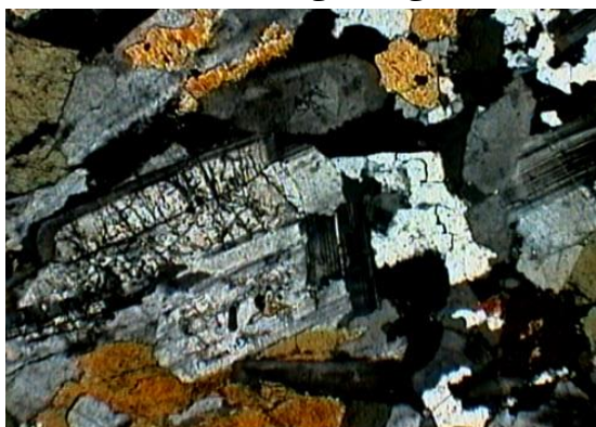
شکل ۱: فرمت دیجیتالی از مقطع نازک متعلق به نمونه سنگ گرانیت چایان
