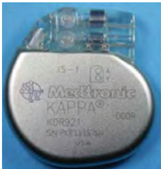
تصویر 5- مجموعه باتری و مدار الکترونیکی در یک قاب فلزی به نام CAN قرار دارند
