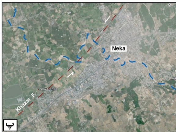
شکل ۱۰: الف) تراشنه حفر شده در عرض گسل جوان خزر که نشانگر پهنه خرد شده و راندگی گسل است. ب) نمای نزدیک‌تر که نحوه شکل‌گیری چین‌های Drag را در راستای گسل‌های راندگی خزر نشان می‌دهد. پ) جابه‌جایی چپگرد رودخانه نکا در امتداد گسل خزر (حسامی و همکاران، ۱۳۸۶).
