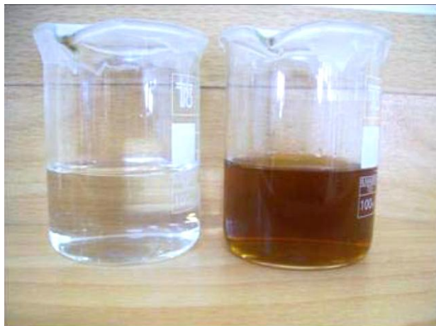
شکل شماره ۱: بشر سمت راست، نانوذرات سنتز شده از پنیرک به روش شیمی سبز؛ بشر سمت چپ، نمک نیترات نقره.
