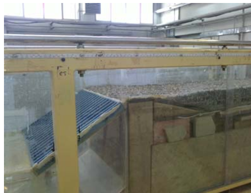
شکل ۴- نمای جانبی رسوبات بالادست کف مشبک
