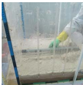
شکل ۴- قرار دادن لوله در لایه‌ی ماسه‌ای
