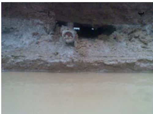
شکل ۱۴- محل شروع فرسایش، الف: حالت بدون لوله، ب: حالت با لوله
