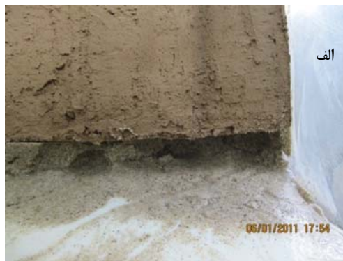
شکل ۱۴- محل شروع فرسایش، الف: حالت بدون لوله، ب: حالت با لوله
