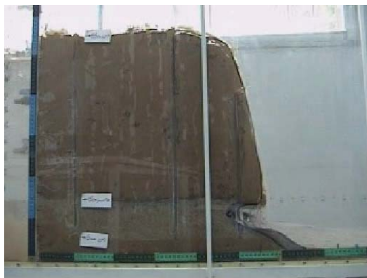
شکل ۵- پسروری مربوط به دانه‌بندی ۰/۸-۰/۴ میلی‌متر
