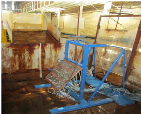
شکل ۱- صفحه و سیستم تکیه‌گاهی تغییر زاویه دیواره درون مخزن سقوط جت
