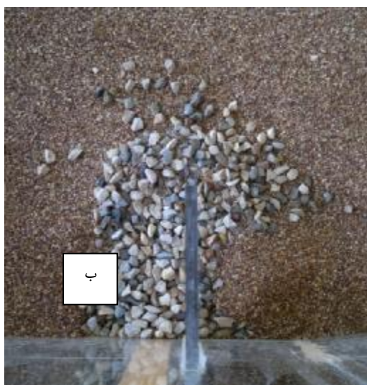
شکل 4- نحوه چیدمان ریپ‌رپ در اطراف آبشکن‌ها: الف) قبل از شکست و ب) بعد از شکست
