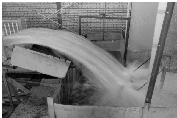
شکل ۴- برخورد جت آب به صفحه اندازه‌گیری فشار
