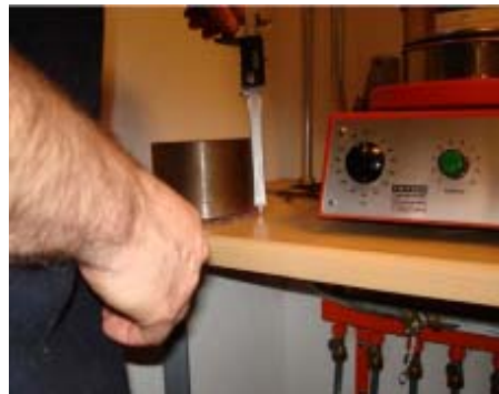
شکل ۱- اندازه‌گیری ضخامت پوشش مصنوعی
