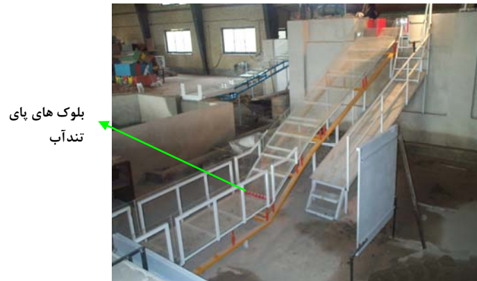
شکل ۱- نمایی از مدل هیدرولیکی حوضچه آرامش سد گلابر در مرکز تحقیقات آب وزارت نیرو
