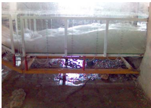
شکل ۳- حالت دوم تشکیل پرش هیدرولیکی، روی بلوک های پای تندآب
