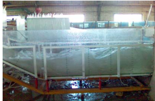
شکل ۴- حالت سوم تشکیل پرش هیدرولیکی، پرش مستغرق
