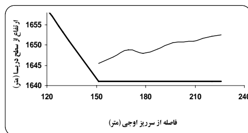
شکل ۹- پروفیل سطح آب در دبی ۴۵۰ متر مکعب بر ثانیه
