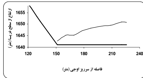
شکل ۱۰- پروفیل سطح آب در دبی ۵۹۲/۹ متر مکعب بر ثانیه
