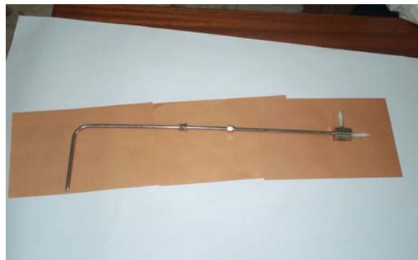
شکل ۵- لوله پیتو جهت اندازه گیری سرعت جریان
