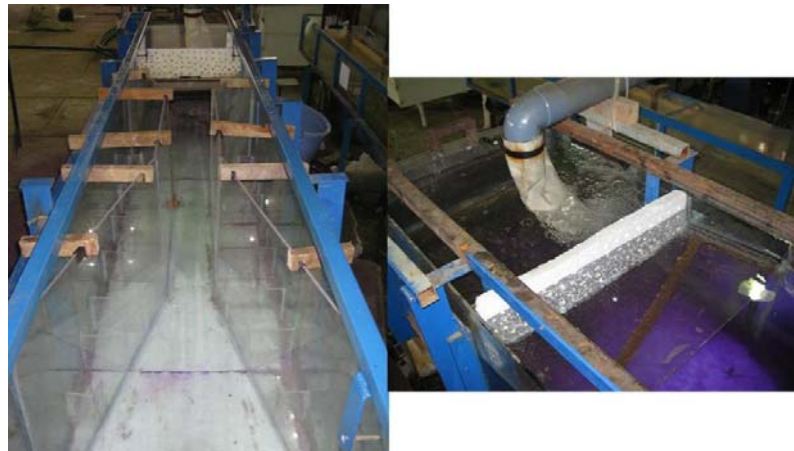
شکل ۲ - تصویری از قسمت انتهایی فلوم و نصب دیواره‌های مقطع همگرا
