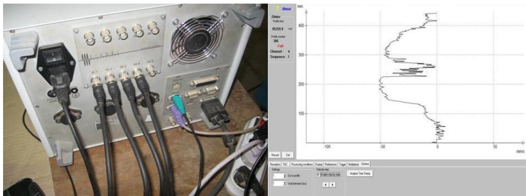
شکل ۳ - نمونه‌ای از پروفیل سرعت برداشت شده و نمایی از دستگاه DOP2000
