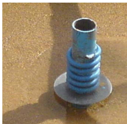
شکل ۸- تأثیر توأم طوق و کابل بر آبستگی
