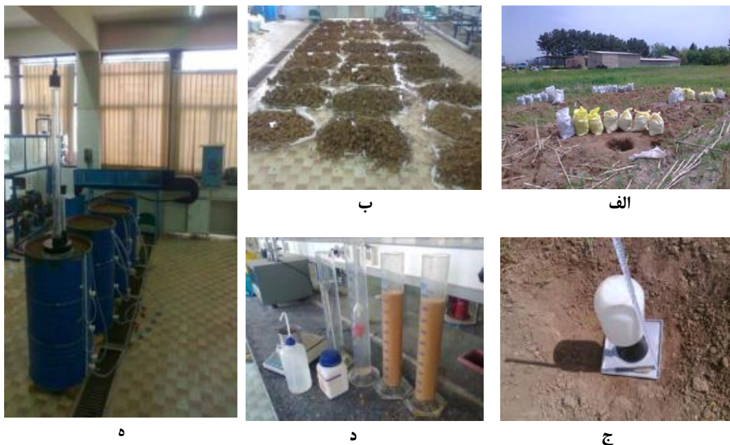
شکل ۱- مراحل انجام آزمایش، الف) جمع آوری داده‌ها از مزرعه، ب) خشک شدن نمونه‌ها در آزمایشگاه، ج) آزمایش اندازه‌گیری تراکم خاک به روش ماسه، د) آزمایش هیدرومتری برای تعیین بافت خاک، ه) انجام آزمایش با دیسک تنشی روی نمونه‌ها
