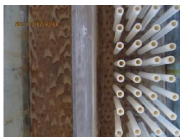
شکل ۴- نمونه‌ای از نحوه نصب و قرارگیری موانع در فلوم آزمایشگاهی
