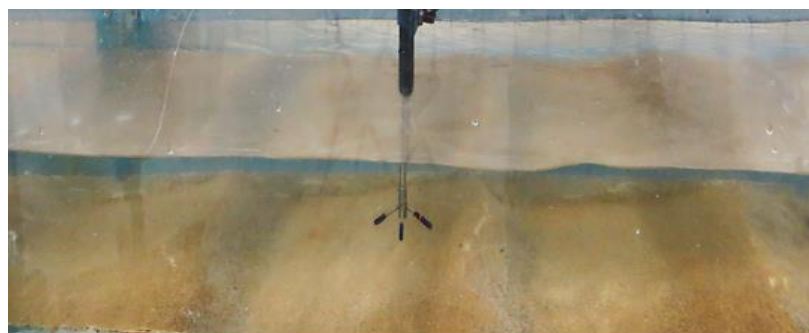
شکل ۲- نمایی از ریپل‌های موازی در کف فلوم آزمایشگاهی و موقعیت سرعت سنج ADV
