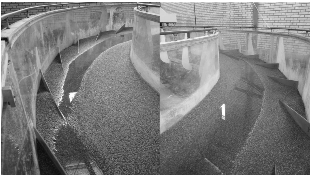
شکل ۲- نحوه نصب صفحات به ساحل خارجی در عدد فرود ۰/۲۴
