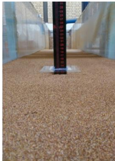
شکل ۳- نمایی از طوقه نصب شده روی پایه در تحقیق حاضر
