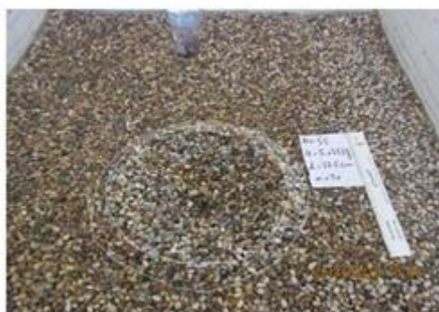
شکل ۳- چاله آبستگی با ارتفاع نصب جت ۳۵/۵ سانتی متر و دانه بندی مصالح ۷/۱۴ میلی متر
