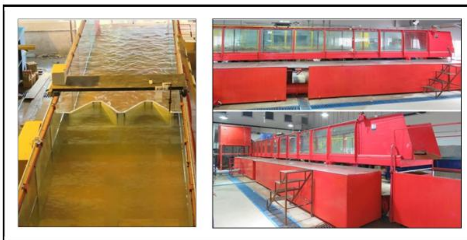
شکل ۳ تصاویری از کانال آزمایشگاهی و سرریز کنگره‌ای پلان دوزنقه‌ای
