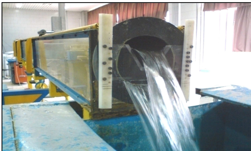
شکل ۱- تصویری از مدل آببندی شده در انتهای کانال
