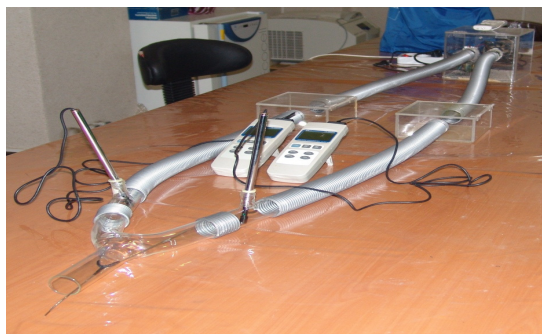
شکل ۱- دستگاه بوسنج مورد استفاده در آزمون‌ها (اصلی).
