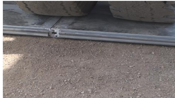
شکل ۱۳- اعمال نیرو توسط تایر کامیون در مرز بین دو صفحه
