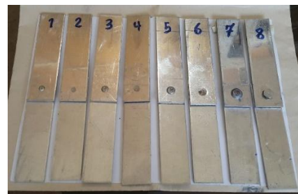
شکل ۱۴ - ورق‌های اتصال یافته به یکدیگر با فرآیند پرچ‌کاری
