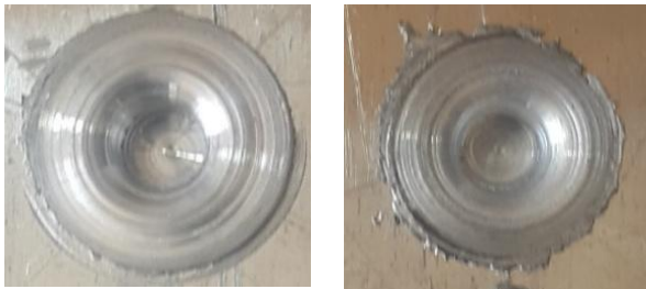
الف- سرعت دورانی ۸۰۰ rpm ب- سرعت دورانی ۱۲۵۰ rpm شکل ۱۲ - تصویر اتصال ایجاد شده در سرعت های دورانی ۸۰۰ rpm و ۱۲۵۰ rpm
