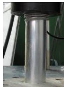
شکل 8 - نمونه استوانه‌ای تحت بارگذاری فشاری شبه‌استاتیکی
