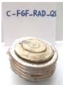
شکل 12 - نمونه استوانه‌ای پر شده با فوم تابعی شعاعی بعد از آزمایش فشار و نمودار L-D آن
