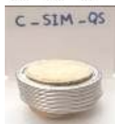
شکل 10 - نمونه استوانه‌ای پر شده با فوم ساده بعد از آزمایش فشار و نمودار L-D آن
