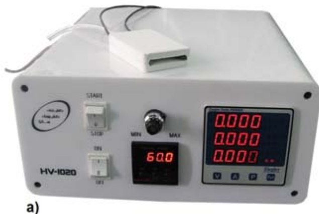
تصویر ۱: (a) نمایشی از دستگاه تولید پلاسما گلایدینگ آرک، (b) شعله پلاسما تابش شده از تورچ دستگاه
