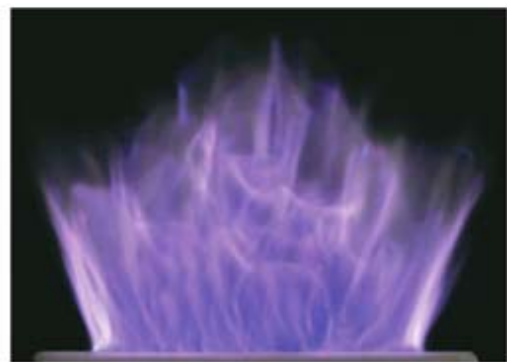
تصویر ۱: (a) نمایشی از دستگاه تولید پلاسما گلایدینگ آرک، (b) شعله پلاسما تابش شده از تورچ دستگاه
