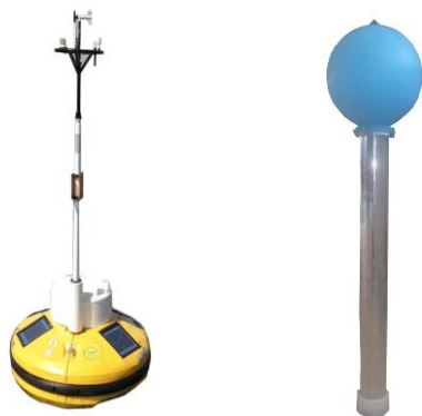
شکل ۹. سونوبوی‌های مورد استفاده برای به‌دست آوردن مجموعه دادگان سوناری (الف) سونوبوی برای ارسال پینگ و دریافت باز پراکنش اهداف (ب) سونوبوی تأمین‌کننده اطلاعات محیطی
