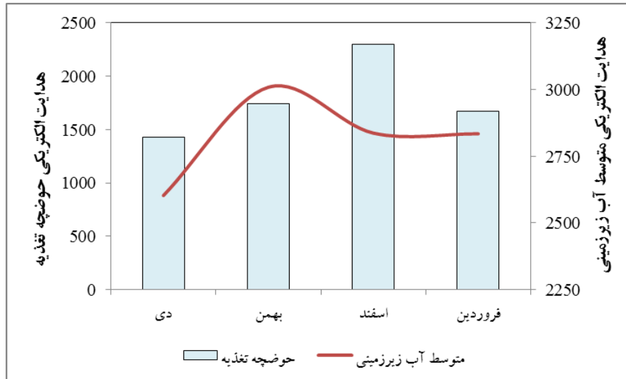
شکل ۶- تغییرات زمانی هدایت الکتریکی آب حوضچه تغذیه و متوسط هدایت الکتریکی آب زیرزمینی
