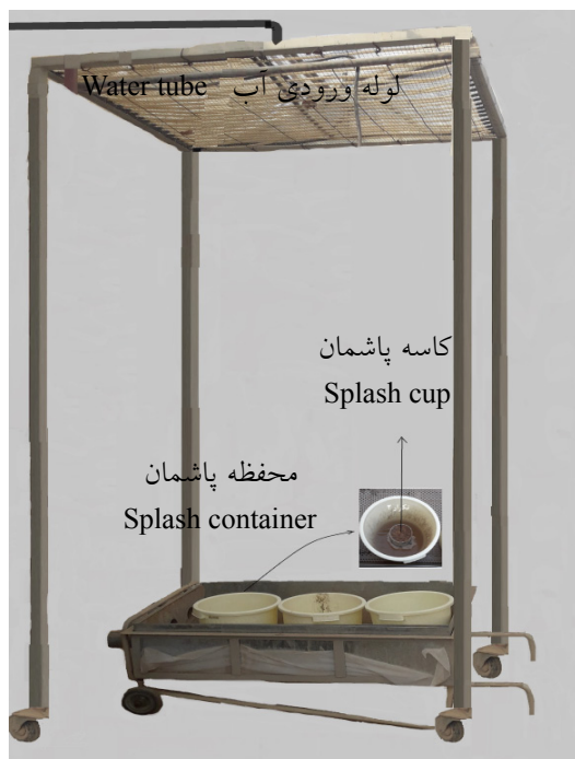
شکل ۱- نمایی از دستگاه باران‌ساز و ظروف پاشمان Fig 1. View of the rainfall simulator and splash cups
