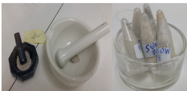
شکل ۲- نمونه‌های آماده شده برای آزمایش ایکس‌اردی
