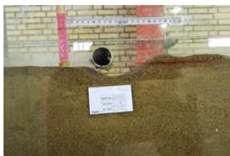
شکل ۴- آبشستگی در زیر لوله با نصب تیغه در انتهای آزمایش Fig 4. The scour formed under the pipe with the attached spoiler at the end of the experiment
