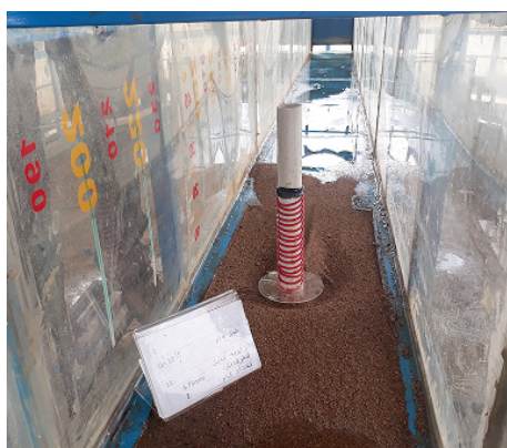
شکل ۷- آبهستگی در اطراف پایه استوانه‌ای با نصب توام کابل و طوقه بعد از آزمایش
