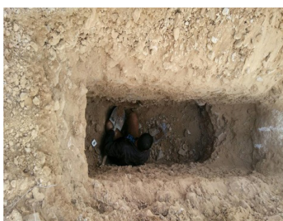
شکل ۲- حفر گودال و نمونه‌گیری از لایه‌های مختلف خاک Fig 2. Pit drill and soil sampling of different layers
