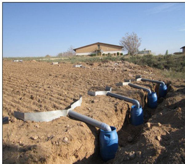
شکل ۱- کرت‌های فرسایشی با طول‌های مختلف در راستای شیب ۱۰ درصد جهت مطالعه هدررفت خاک تحت باران‌های طبیعی Fig 1. Erosion plots with different lengths installed on 10% slope to study soil loss under natural rainfalls
