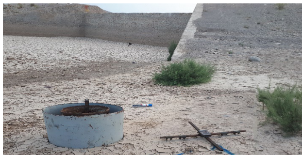
شکل ۲- محل استقرار استوانه مضاعف در بند صدرآباد
