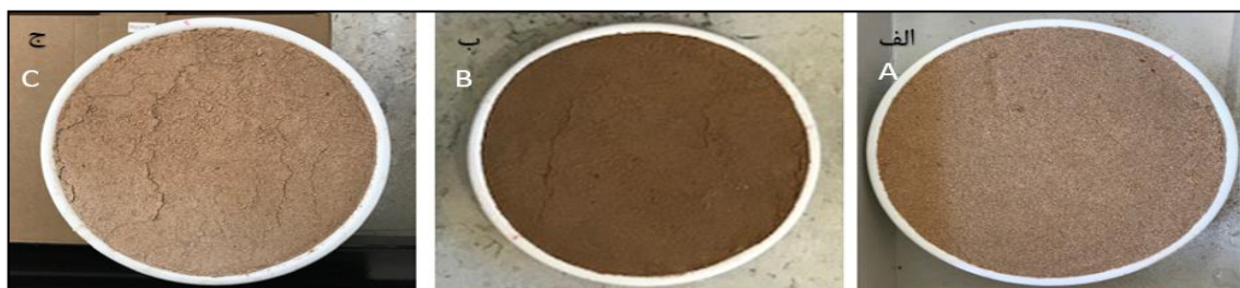
شکل ۲- الف: نمونه خاک آماده شده پیش از مالچ‌پاشی، ب: نمونه‌ها پس از مالچ‌پاشی، ج: سطح نمونه پس از خشک شدن
