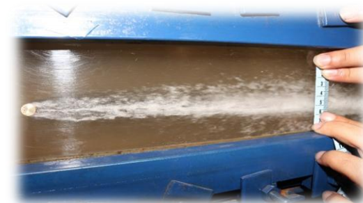
شکل ۱۲- پدیدار شدن حالت سوپر کاویتاسیون همراه با اندازه‌گیری ضخامت حباب
