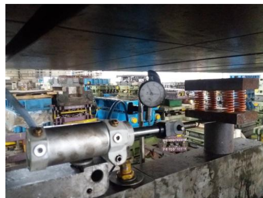
شکل ۱۶- تجهیزات آزمایش اصطکاک کلمب
