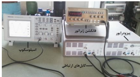
شکل ۴- تجهیزات تست و تنظیم فرکانس
