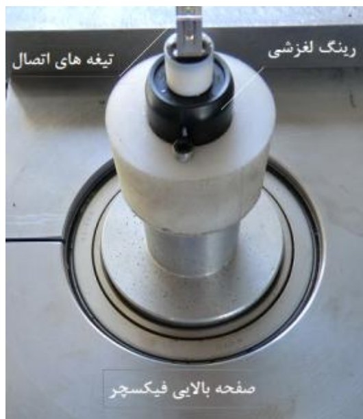
شکل ۳- مونتاژ رینگ لغزشی بر روی سیستم
