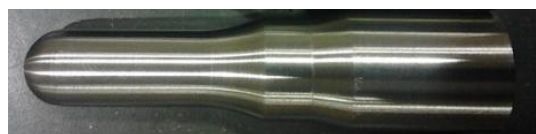
شکل ۸- ساخت ابزار شکل‌دهی مرتعش به قطر ۲۰ میلی‌متر
