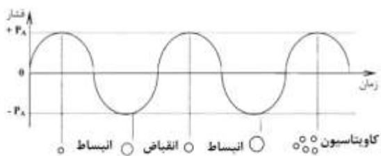
شکل ۱- ساز و کار حفره‌زایی صوتی [۲۲]
